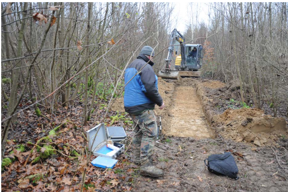
Baggerschurf auf Rückegasse bis auf gewachsenen Boden (Foto: Landratsamt Konstanz, Jürgen Hald).
